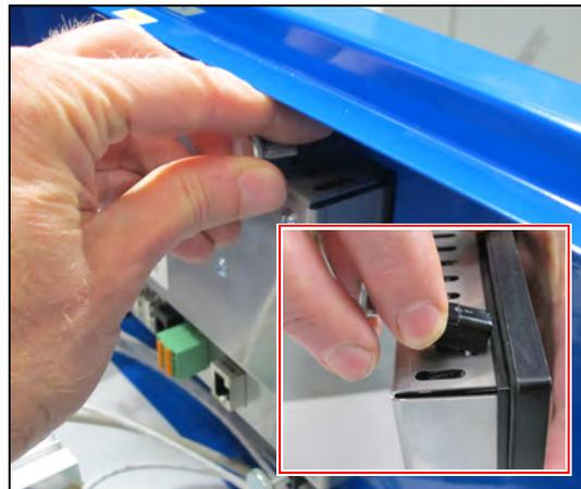
7. Die neue CONTROL2015 touch von vorne in das Gerät schieben.
