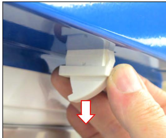
5. Neuen Türkontaktschalter nach oben in die Einbauöffnung schieben bis die Klemmnasen hörbar einrasten. Einbaurichtung beachten: Nocke zeigt nach hinten (siehe Foto).
