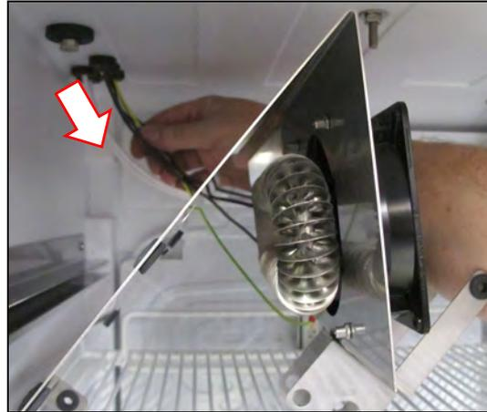
16. Vier Befestigungsschrauben des Umluftlüfters lösen und entfernen.
