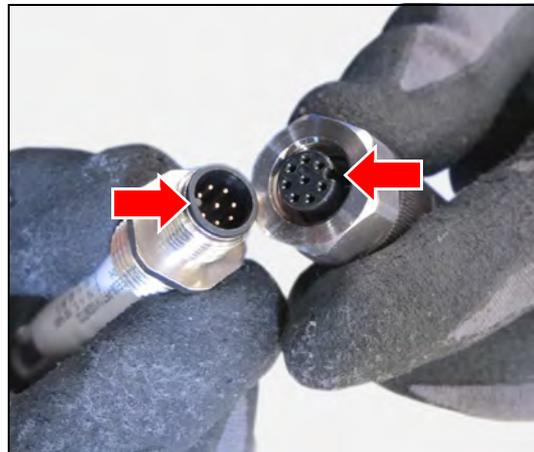
8. Neuen Feuchtesensor in die Halterung schieben.
