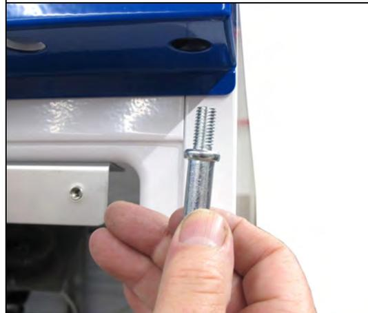
17. Oberen Türhaltebolzen auf der anderen Seite des Gerätes einschrauben und mit einem Gabelschlüssel festziehen.
