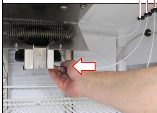
31. Übertemperatursensor seitlich in die Halterung schieben.
