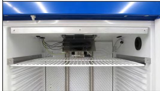
9. Je LED-Leiste drei Hutmuttern lösen und entfernen.
