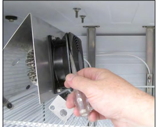
**12. Die drei Kabel des alten Umluftlüfters am Klemmstein lösen.**
