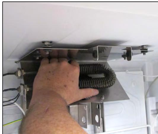
28. Lüfterblech über Kreuz mit je einer Unterlegscheibe und einer Schraubenmutter befestigen.
