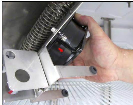
18. Vier Befestigungsschrauben des Umluftlüfters einschrauben und festziehen.
