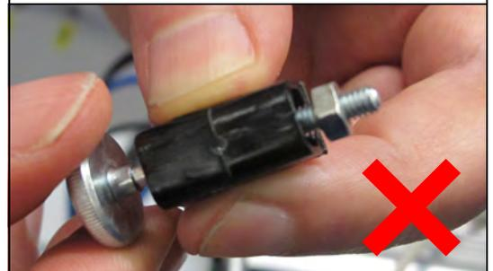
10. Beim Einsetzen der Halterungen die Nase in den breiten Teil der Befestigungsöffnung einsetzen.
