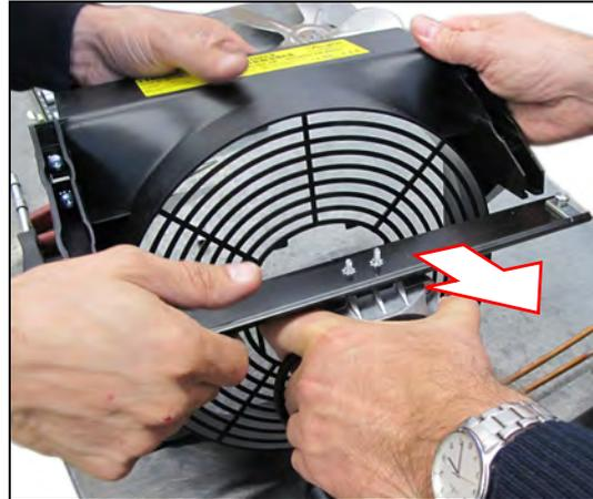
11. Neuen Lüftermotor in Haltesteg schieben.
