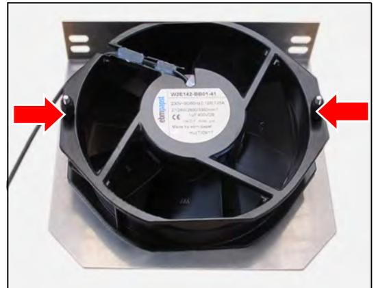
9. Zwei Befestigungsschrauben am Lüfter lösen und entfernen.
