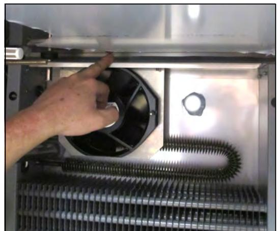
5. Zwei Hutmuttern an der Rückwand aufsetzen und festziehen.
