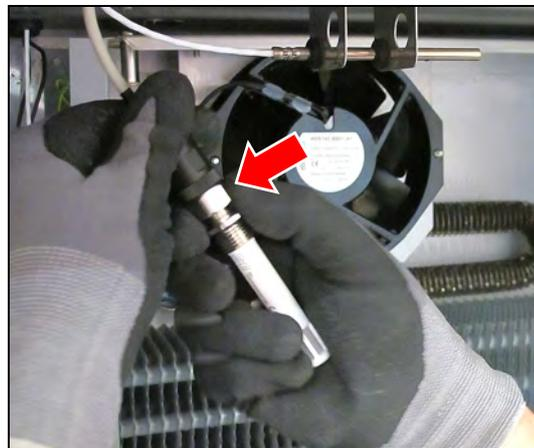
6. Feuchtesensor seitlich durch die linke Seite der Halterung, durch die Befestigungsmutter und durch die rechte Seite der Halterung schieben.
