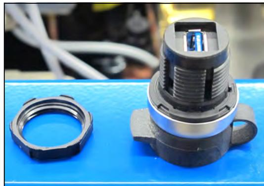
6. Neues USB-Einbaugehäuse von vorne einsetzen.
