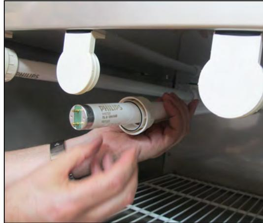
5. In beiden Schraubringen prüfen, ob die rote und die schwarze Dichtung intakt sind.
