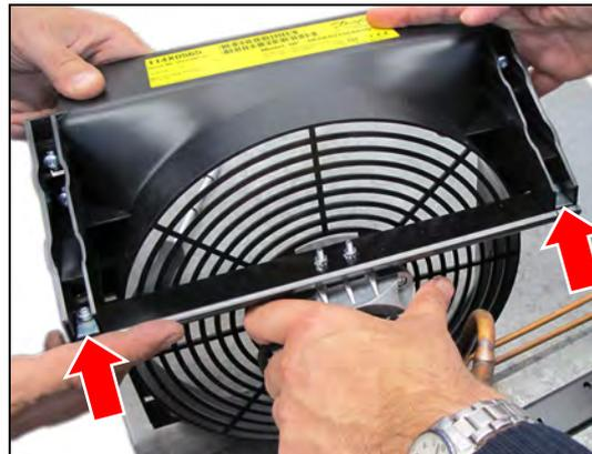
15. Lüfterrad aufsetzen. Einbaurichtung beachten!
