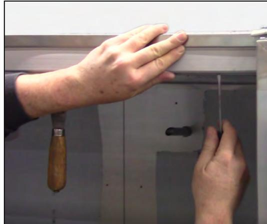
7. Unter dem Türrahmenprofil befindet sich die mit Aluminiumklebeband befestigte Heizung.
