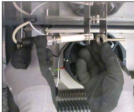
7. Befestigungsmutter an der Halterung des Feuchtesensors festziehen.
