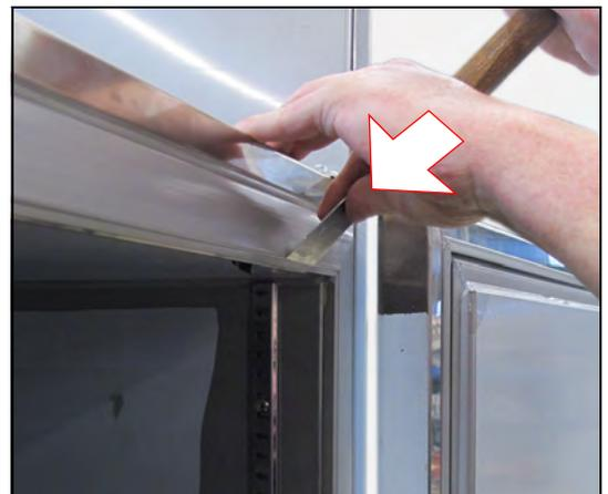
3. Türrahmenprofil aushebeln
