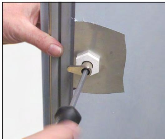
3. Mit einer Rohrzange die Verschraubungshülse des Schlosses lösen und entfernen.
