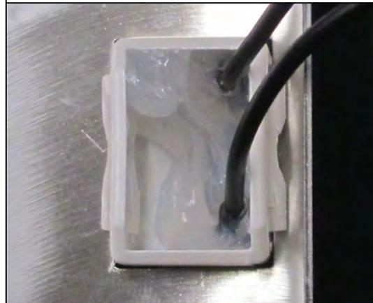
14. Restlichen Kabelanschlussbereich mit dünnflüssigem Silikon vergiessen.
