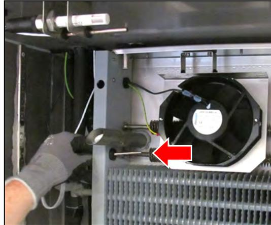
10. Temperatursensor seitlich in die Halterung schieben.
