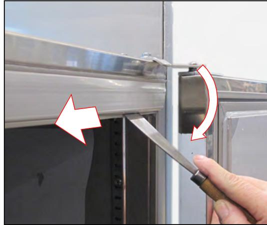
5. Mit einem weiteren Werkzeug das Türrahmenprofil endgültig lösen und entfernen.
