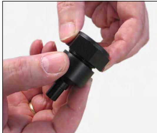
3. Kugel des Kondensatablaufventil reinigen, bzw. bei Schäden austauschen.
