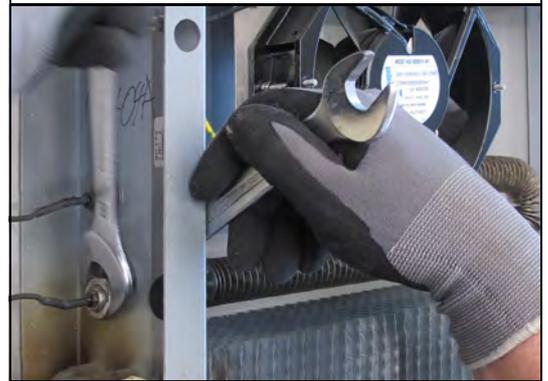
8. Rippenrohrheizung aus den Bohrungen ziehen und durch leichtes Kippen am Lüfter vorbei aus dem Prüfraum entfernen.
