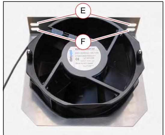
24. Zwei Schraubenmutter (mit Federring und Unterlegscheibe) am Lüfter aufschrauben. Noch nicht festziehen.
