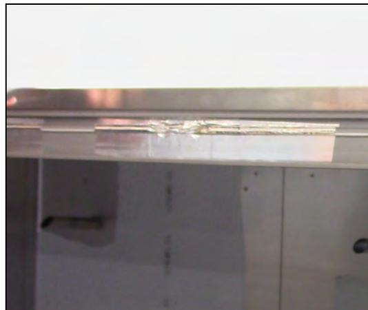
9. Silikonabdichtung der Heizungsdurchführung mit einem geeigneten Werkzeug entfernen.
