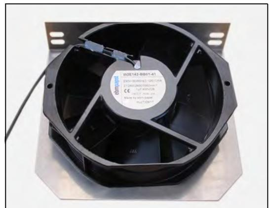
12. Lüfter und Trägerblech verschrauben (2 Schrauben).
