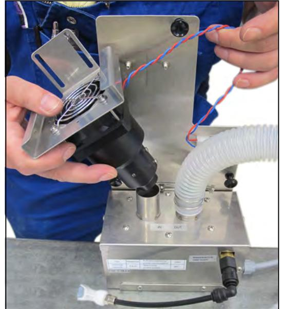
12. Vier Schrauben am Befestigungsblech des Lüfters lösen.
