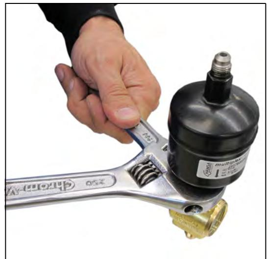
31. Sicherstellen, dass sich die Kupferdichtung in der Verschraubung am Schauglas befindet.
