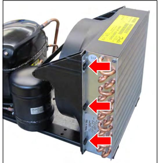
18. Vier Befestigungsschrauben einsetzen und festziehen.
