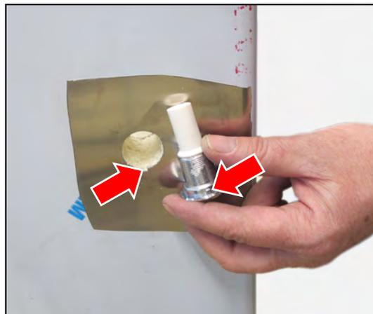
6. Verschraubungshülse von der Innenseite der Tür einsetzen
