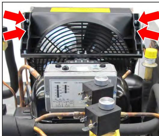
4. Lüfterradkasten leicht anheben damit die Befestigungshaken frei kommen, dann den Lüfterradkasten herausziehen.
