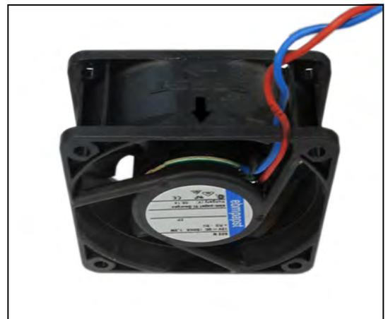
14. Rotes und blaues Kabel des Lüfters aus der Lüsterklemme am Befestigungsblech der Ultraschallbefeuchtung lösen.
