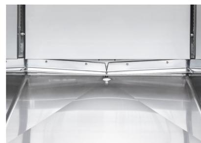
Prüfraumboden mit Gefälle zum Kondensatablauf.
