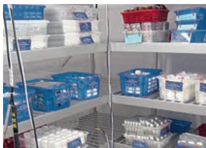
В климатической камере проводятся испытания стабильности лекарственных средств согласно руководству ICH.
