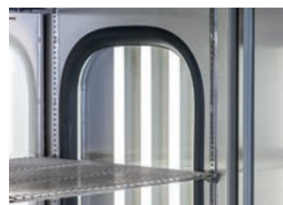
Много света, но не слишком много тепла: эти люминесцентные трубки термически отделены от камеры.
